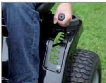
Ajuste manual de la altura de corte:
