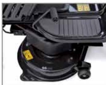
Su carcasa de corte de 96 cm asegura una perfecta calidad de corte. Soportes de eje de cuchilla en aluminio, equipados con robustas cuchillas de corte de acero templado.
