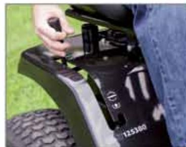
El embrague de cuchillas se activa manualmente a través de una palanca.
