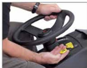
Embrague eléctrico para accionar las cuchillas.
