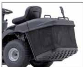
Su amplio recogedor de 280 litros es fácil de vaciar. El usuario puede accionar la palanca para vaciar el recogedor sin dificultad.
