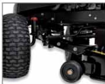
El eje delantero está fabricado solidamente en fundición para dotarlo de extrema resistencia.
