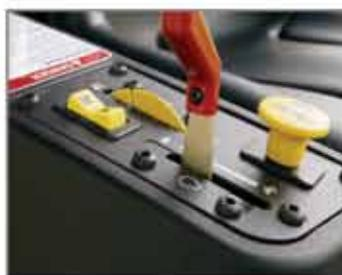
Hemos reflexionado mucho para hacer que los controles EZT2042F vayan como un guante. Tiene el acelerador, el embrague de cuchillas y el ajuste eléctrico de la altura de corte al alcance de sus dedos.
