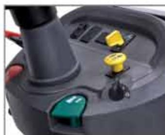
La conexión de las cuchillas se hace de forma sencilla basta con accionar el conmutador eléctrico. Control de velocidad de cruce es de serie en el modelo EMT17538RDF.
